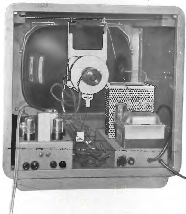
Fig. 7. - Il televisore è terminato. Innezzati gli spinotti e collocati i fili d'unione tra le morsettiere, innestata la spina-presa dell'interruttore, il clips con ventosa sul tubo e la piastrina d'antenna, l'apparecchio, in questa sede, sarà soggetto solo alla messa a punto del centratore della bobina di fuoco, della trappola ionica ed eventualmente dei compensatori del telaio di sincronismo per i quali sono stati praticati due appositi fori. Saranno regolati naturalmente i bottoni di comando sia frontali che i quattro retrostanti (vedi testo). La taratura, il controllo tensioni ecc. sarà stata fatta prima del collocamento nel mobile secondo quanto detto nel corso dell'articolo.
